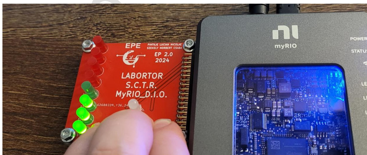
Fig. 35 – Acționarea butoanelor cu apăsare și revenire din cadrul plăcuței modulare
