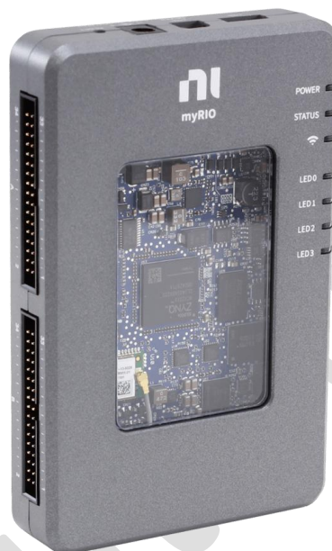
Fig. 4 – MyRIO 1900 – platformă de dezvoltare cu arie de porți programabilă (eng. FPGA)
