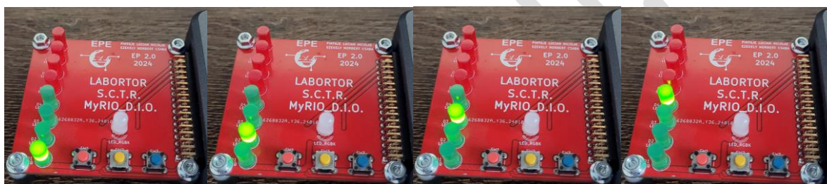
Fig. 45 – Modul de lucru „baleiere pozițională a șirului de indicatori luminoși”
