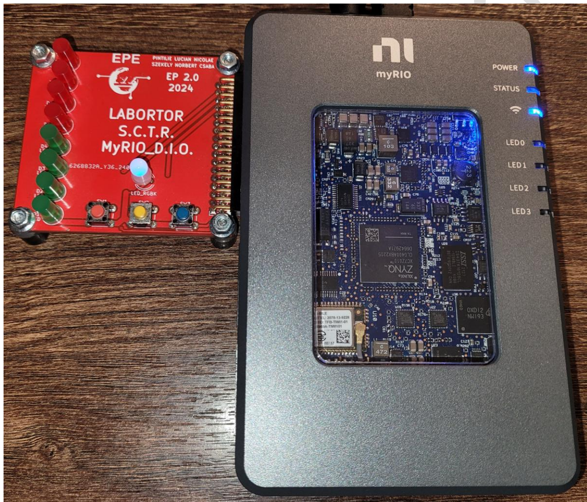
Fig. 13 – Atașarea plăcuței modulare nr. 1 la platforma de dezvoltare NI MyRIO 1900
