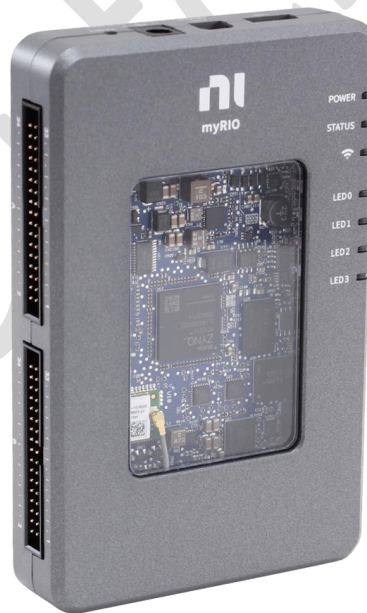
Fig. 7 – MyRIO 1900 – platformă de dezvoltare cu arie de porți programabilă (eng. FPGA)
