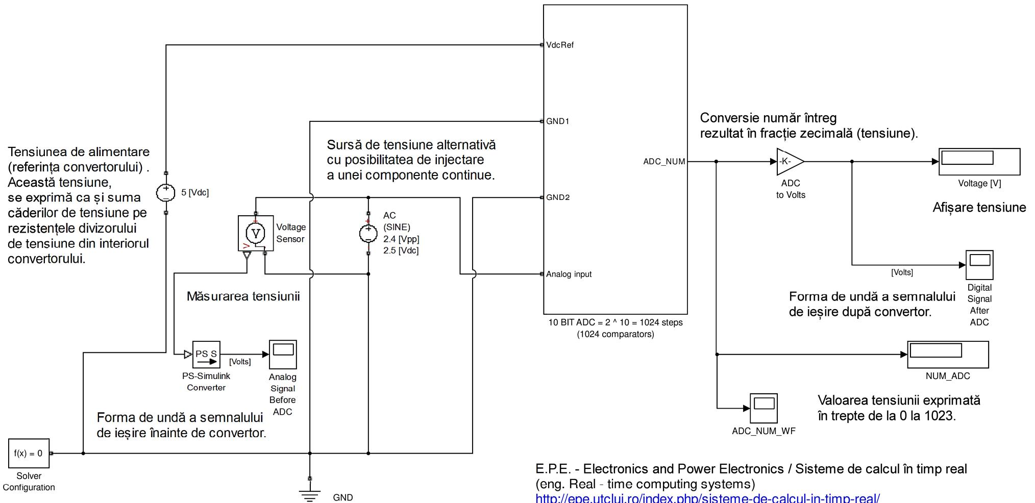
Acest bloc, stabilește metoda de rezolvare al ecuațiilor circuitului, dar și parametrii necesari în vederea simulării circuitului, precum: pas de discretizare, timp de eșantionare, condiții initiale.
