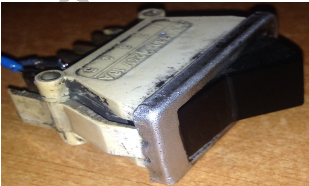
fig. 5 - Întreruptor / comutator unipolar cu o singură traptă de comutație
