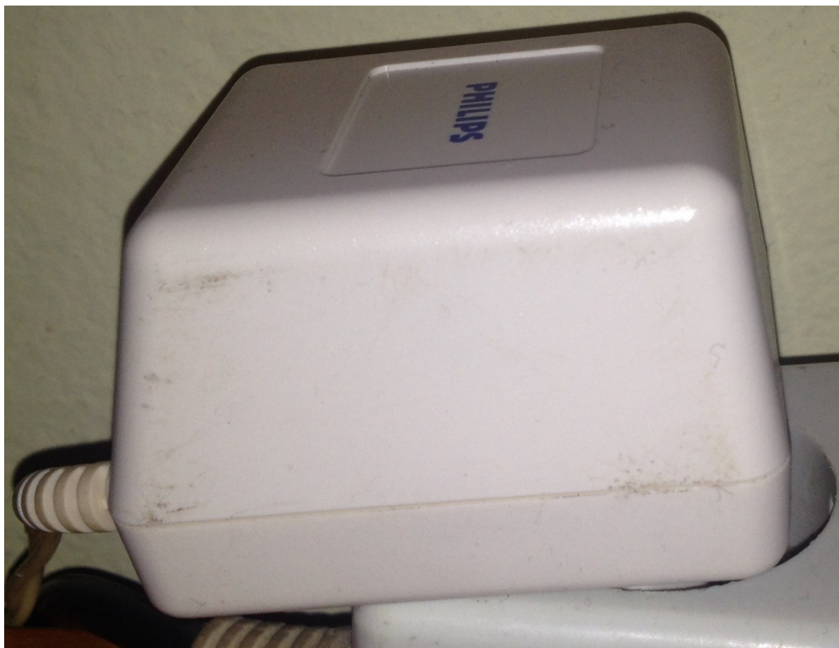
fig. 6 - Sursă de alimentare U_{IN} = 220 [V]; U_{Ieș} = 12 [V]
