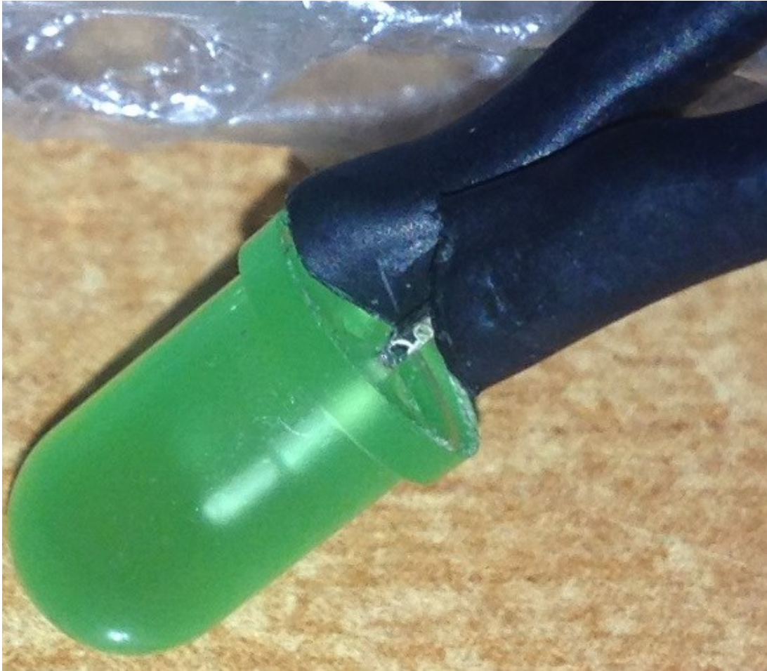
fig. 4 - Diodă electro-luminiscentă U_N = 3,3 \sim 5 [V];
