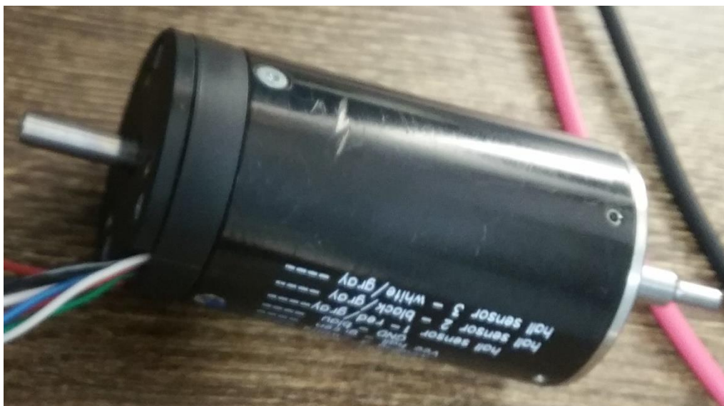
Fig. 9 – Mașina electrică fără perii cu magnet permanent și senzori cu efect Hall
