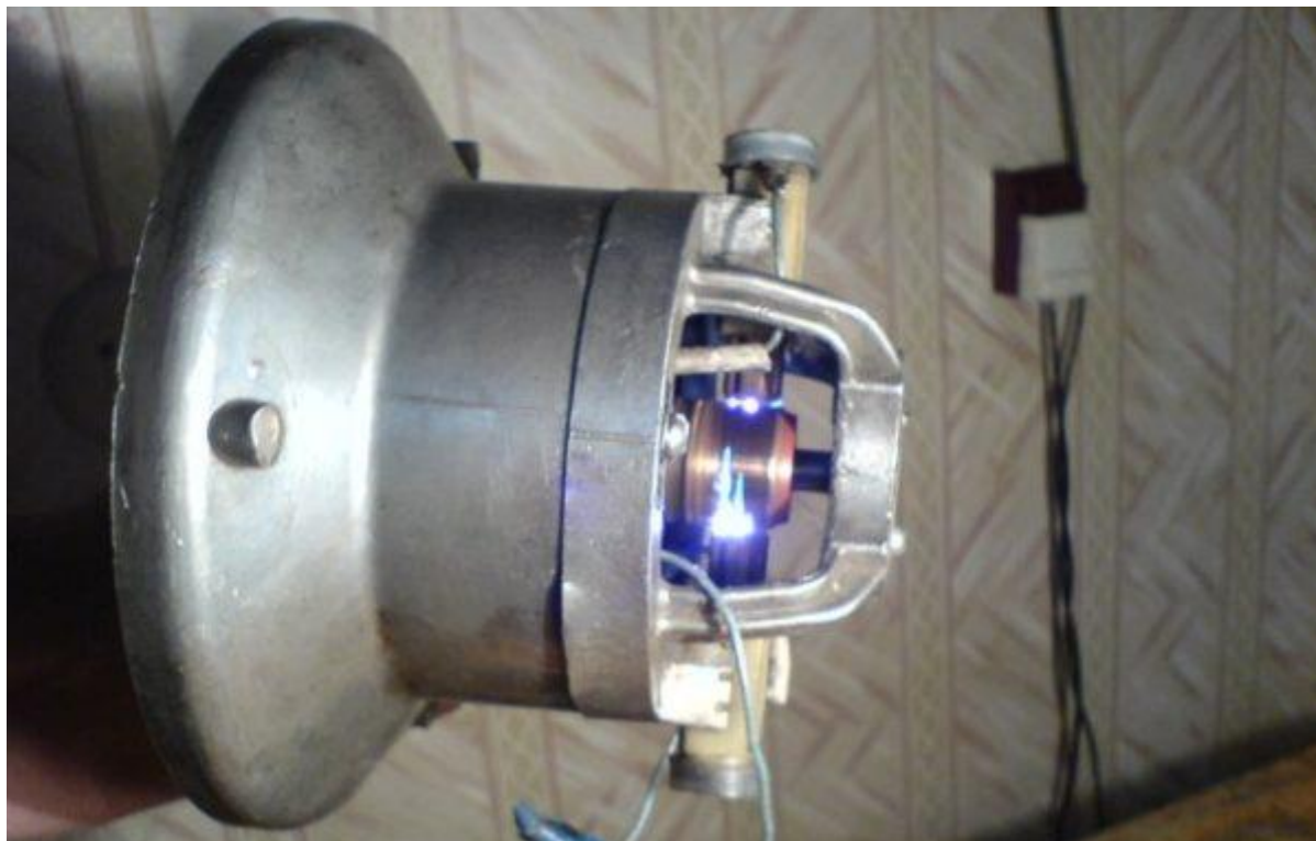
Fig. 3 – Efectul de scânteiere continuă la nivelul colectorului [3]
