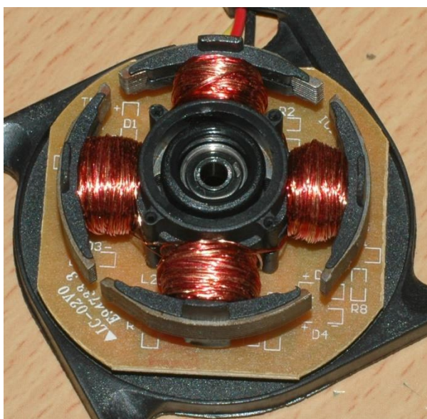
Fig. 6 – Statorul unui ventilatorului de calculator ca fiind o mașină electrică fără perii cu magnet permanent [6]
